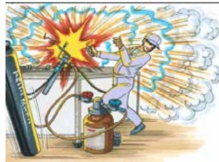
タンクの補修を行う時はタンク内の換気を行い、可燃性ガス等が充満した状態で溶接作業等を行わない
